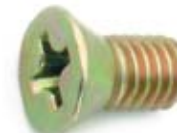
Código: 1612A Quant. 20 Parafuso de carcaça da partida Perkins. (Philips) 3 / 8 UNC x 17 mm.
