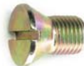
Código: 1610 Quant. 20 Parafuso de carcaça da partida Perkins. 3 / 8 UNF x 17 mm.
