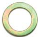
Código: 0017 Quant. 100 Arruela de aço da partida VW – todos. Bosch / Wapsa 12,5 x 19 x 0,6 mm.
