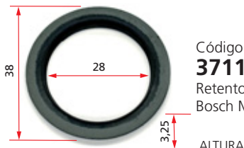
Código: 3712 Quant. 01 Retentor do alternador Bosch Wapsa ônibus MB 105 ampères.
