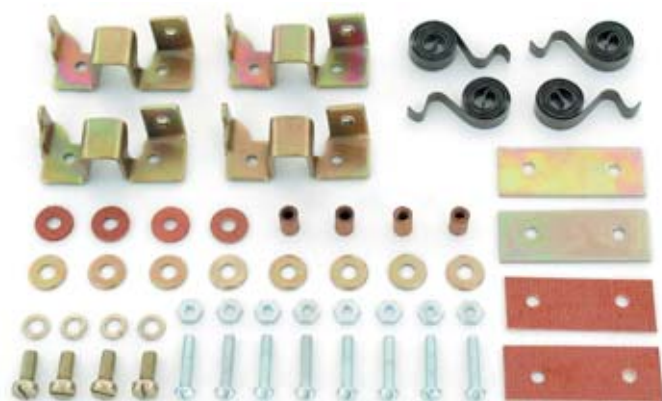
Código: 2078 Quant. 01. Reparo do portaescovas partida Trator Valmet positivo e negativo.
