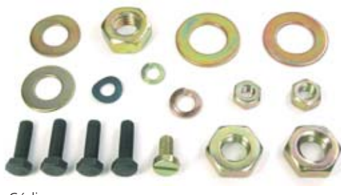
Código: 2071 Quant. 01. Reparo da partida MB JE porcas saída bobina.
