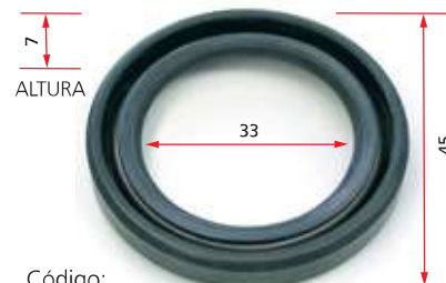
Código: 3718 Quant. 01 Retentor da partida Bosch KB / MB (rígido com mola).
