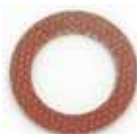
Código: 0616 Quant. 20 Arruela de celeron da partida VW. Bosch pequena 12,5 x 19 x 1 mm.
