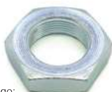
Código: 1649A Quant. 05 Porca da polia alternador 140 ampères - M27 x 1,5 chave 41.
