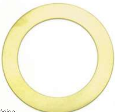
Código: 1031 Quant. 10 Arruela de latão da partida KB / MB. Bosch 41 x 58 x 0,5 mm
