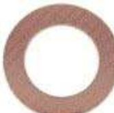
Código: 0150 Quant. 20. Arruela de celeron do alternador. Bosch e Delco 17 x 26,5 x 1 mm.
