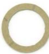
Código: 0605 Quant. 20. Arruela de velumóide da partida guarnição graxa. Bosch 20 x 26 x 1 mm.
